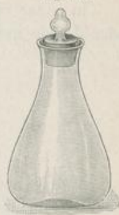
Jodabsorptionsgefäß nach B. Fischer.
