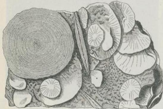
Fig. 66. Bruchfläche eines Stückes Nummulitenkalk der Pyramiden von Gizeh. (Vergrößert.)
