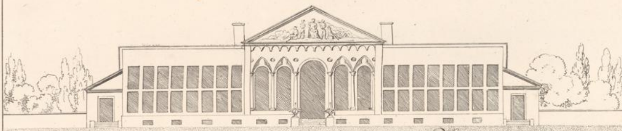
Vordere Ansicht von der Orangerie (s. und s.) des kalten und warmen Hauses.
