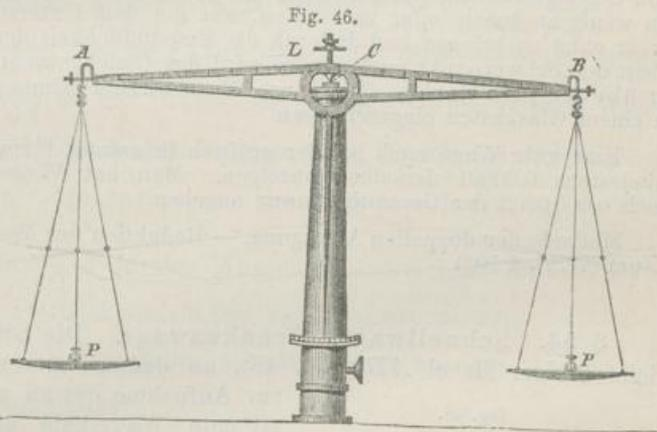
Ebene liegen müssen, sind die beiden Wagschalen aufgehängt. Der Wagebalken soll, wenn beide Schalen mit gleichen Gewichten  $P$  belastet sind, in horizontaler Lage in stabilem Gleichgewicht sein. Dazu ist erforderlich, dass der Schwerpunkt  $S$  (Fig. 47)
