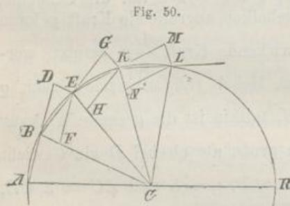
Um die Größe der Centralkraft zu bestimmen, welche erforderlich ist, um einen Körper in seiner kreisförmigen Bahn zu erhalten, denke man sich die stetig wirkende Kraft zunächst durch eine Reihe in sehr kurzen Zeitintervallen wirkender Momentankräfte (§ 31a) ersetzt. Der Körper, dessen Dimensionen der Einfachheit wegen als verschwindend klein betrachtet werden mögen, durchlaufe die Sehne  $AB$  des Kreises (Fig. 50) in  $\frac{1}{n}$  Sekunde mit der Geschwindigkeit  $v$ , so
