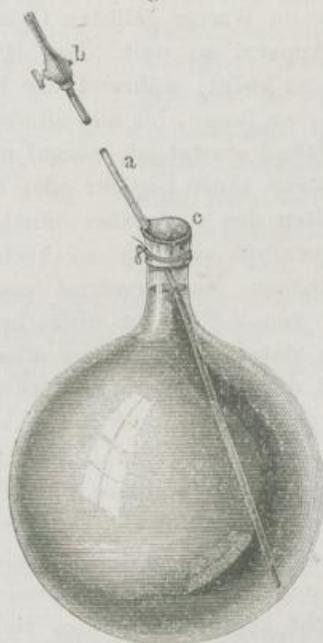
hinabreichenden Röhre von Gutta-Percha *a* das Wasser aus dem Gefässe so lange auf, bis es vollständig durch anderes ersetzt ist. Um bei den Unterbrechungen des Aufsaugens den Rückfluss des Wassers im Rohre zu verhindern, dient der Hahn *b* oder ein kleines Röhrenstück von vulkanisirtem Kautschuk, das man durch Zusammendrücken mit den Fingern schliessen kann. — Der Kolben ist ventilartig mit einer vulkanisirten Kautschukplatte *c* überbunden, die vermöge ihrer Elasticität
