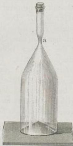
Dieselben werden wie es Fig. 159 zeigt, mittelst eines Korkes oder Kautschukrohres zum Behufe der Auffangung des Gases mit einem Trichter luftdicht verbunden. Die Röhren sind bei *a* bis zur Dicke eines dünnen Strohhalmes vor der Lampe ausgezogen. Sollen grössere Gasmengen aufgefangen werden, so benutzt man Arzneiflaschen mit ausgezogenem Halse (Fig. 160). Nachdem man die Röhren
