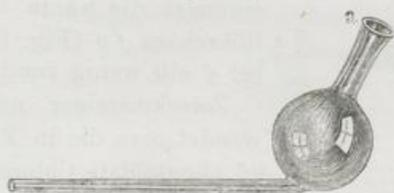
10. Eine an beiden Enden offene, etwa 60 Cm. lange Glasröhre, welche so weit ist, dass sie sich über den Schnabel des Verbrennungsröhres schieben lässt; dieselbe wird beim Gebrauch an ein Filtrirgestell (siehe Fig. 108) angelehnt.
