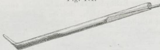
Das Füllen der getrockneten und mit etwas Kupferoxyd ausgespülten Röhre geschieht auf folgende Weise. Man bringt zuerst in das hintere Ende derselben eine etwa 10 Cm. lange Schicht Kupferoxyd, dadurch, dass man das Verbrennungsrohr in die das Kupferoxyd enthaltende Röhre oder den Kolben einschiebt (Fig. 110) und bei schiefer Richtung etwas klopft.
