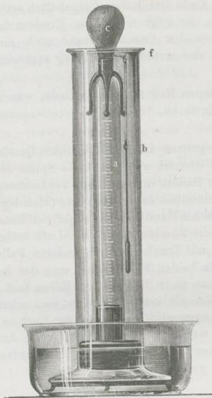
In den äusseren Cylinder *b* bringt man eine etwa 15 Millim. hohe Quecksilberschicht. Den Messcylinder füllt man vollkommen mit Quecksilber, am besten mit darin ausgekochtem, und stürzt ihn in eine flache Quecksilberwanne um. Man bringt nun eine gewogene Menge der zu verdampfenden Flüssigkeit in ein vor der Lampe ausgeblasenes dünnwandiges Glaskügelchen (Fig. 149), lässt dasselbe
