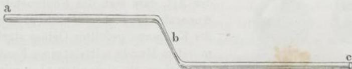
zwei fertige Verbrennungsröhren. Man sehe darauf, dass der hintere Theil der Röhre so gestaltet sei, wie es Fig. 89, nicht aber so, wie es Fig. 90 zeigt, sowie dass die Oeffnung beim Umschmelzen der Ränder
