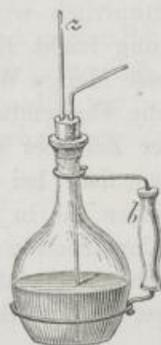
werden, dessen Construction keiner weiteren Erläuterung bedarf. Die Spitze *a* ist an ihrem Ende ausgezogen und abgekneipt. Dreht man den Kolben um, so läuft aus derselben von selbst ein continuirlicher feiner Strahl aus.
