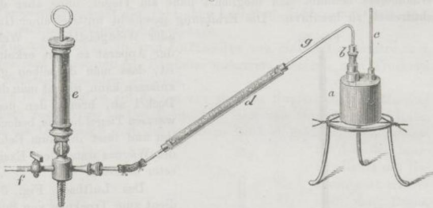
*a* ist ein oben mit zwei Oeffnungen versehenes, mit Messing gelöthetes Gefäss von starkem Kupferblech, *b* ein Glasröhrchen, in welchem sich die Substanz befindet, *c* ein Thermometer, *d* eine Chlorcalciumröhre, *e* eine kleine Handluftpumpe.
