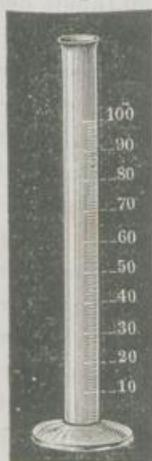
β. Messgefässe, welche beim Entleeren so viel Flüssigkeit ausfliessen lassen, als die auf denselben angebrachten Marken besagen. (Auf Ausguss, à l'écoulement, graduirte Messgefässe.)
