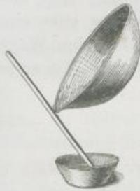
Hat man das Salz nunmehr in der Schale, in welcher es gewogen werden soll, und ist die Flüssigkeit soweit verdampft, als dies im Wasserbade zu erreichen ist, so hat man zu unterscheiden, ob das Salz geglüht werden kann oder nicht. Ist das Erstere der Fall, so bedeckt man die Schale mit ihrem Deckel von dünnem Platinblech (in Ermangelung eines solchen wohl auch mit einer dünnen Glasplatte) und erhitzt hoch über der
