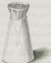
stelligen kann, so lässt man es in dem Trichter fast trocken werden, indem man denselben, mit Fliesspapier zugekehrt, in einem zerbrochenen Becherglase (Fig. 55) oder dergleichen auf den Dampfapparat, das Sandbad, den Ofen oder eine erhitzte Eisenplatte stellt. Sehr gut dienen zu diesem Zwecke unten und oben offene Kegel von Steingut oder
