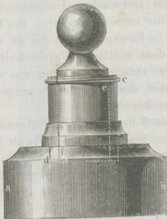
Bei Mineralien, von denen man nur wenig hat, überhaupt wenn Verlust vermieden werden soll, bedient man sich zum Zerstoßen eines Stahlmörser, Fig. 24. *ab* und *cd* sind die zwei leicht auseinander zu nehmenden Theile des Mörsers. Die zu zerstoßende, wo möglich schon in kleine Stückchen zerschlagene Substanz bringt man in die cylindrische Höhlung des letzteren *ef*. Als Pistill dient ein in die Höhlung passender Stahleylinder. Bei der Operation stellt man den Mörser auf eine feste
