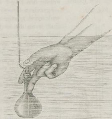
Loch ist. Man steckt durch dasselbe den Hals der Flasche, bindet das Netz unter dem Boden derselben zusammen, hängt unten ein hinlänglich schweres Gewicht an und befestigt am Halse der Flasche eine starke Schnur.
