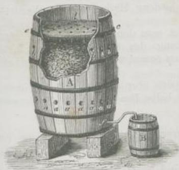
ist, wobei überdies die verwesenden Hobelspäne Sauerstoff übertragend zu wirken scheinen und endlich bis auf den eigentlichen Boden des Fasses gelangt, wo es nun schon theilweise in Essig verwandelt ist. Der sich unten ansammelnde Essig fließt durch das heberförmige Rohr *f* in ein vorgestelltes Gefäß *B*. Gewöhnlich muss man den Essig zwei- bis dreimal durch den Essigbildner laufen lassen, bis er fertig ist.
