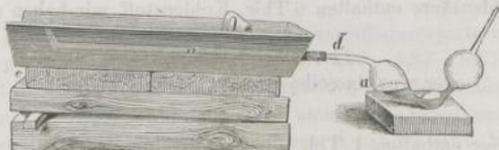
Das Ammoniak wird von der Salzsäure vollständig absorbiert, während Wasserstoff und Kohlenwasserstoff entweichen, und Kohlensäure von dem Natronkalk zurückgehalten wird. Nach beendigter Verbrennung
