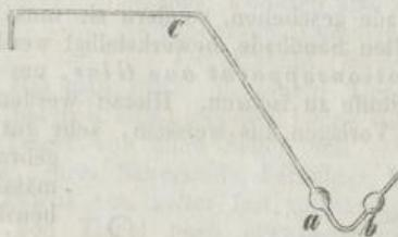
indem sie das Heraus- und Hineindringen der nöthigen Luftmenge gestatten. Nöthigen Falls muss die Vorlage in einer Schüssel mit kaltem Wasser umgeben und durch Umschlagen von nassen Tüchern abgekühlt werden.
