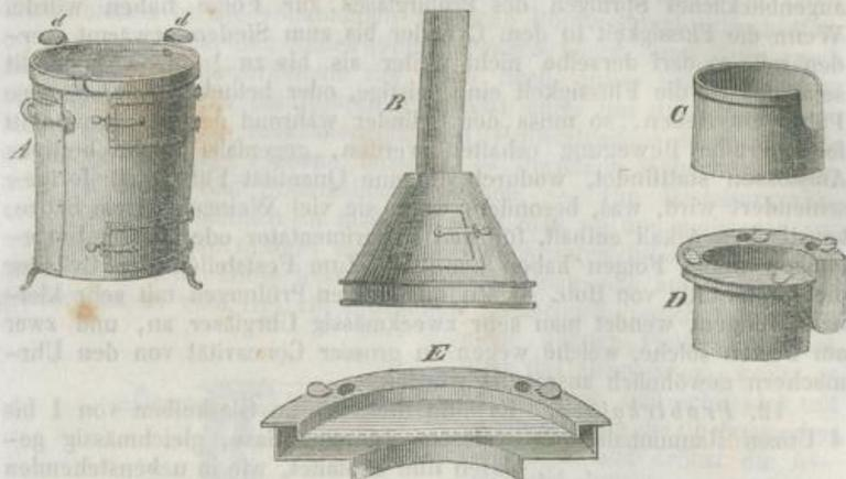
Ofen passt und zur Aufnahme der tiefen Kapelle *D* bestimmt ist, wenn der Ofen zu Destillationen oder der flachen Kapelle *E* wenn er zu Digestionen im Sandbade benutzt wird. Die Kapelle ruht mit dem breiten Rande auf dem Aufsatze auf und es befinden sich in diesem Rande mehrere Oeffnungen mit Schiebern behufs der Regulirung des Feuers.
