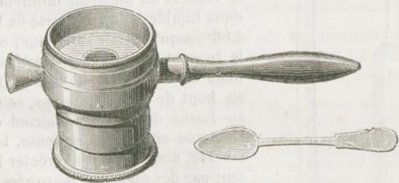
Fig. 863. — Lactoscope de M. Donné.
