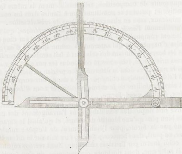
Fig. 1. — Goniomètre par application de Garangeot.
