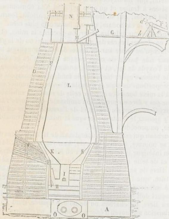
Fig. 145. — Coupe d'un haut fourneau parallèlement aux tuyères \*.
