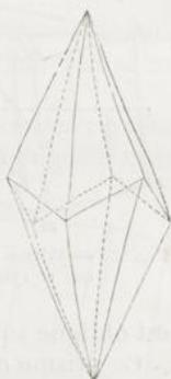
Fig. 54. — Dodécaèdre à triangles scalènes.
