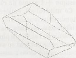
Fig. 97. — Plomb sulfuré.
