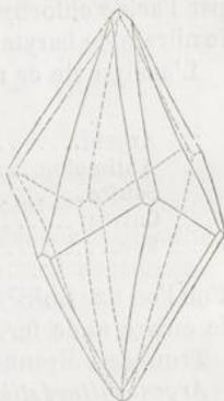
Fig. 89. — Argent rouge en dodécaédre à triangles scalènes.
