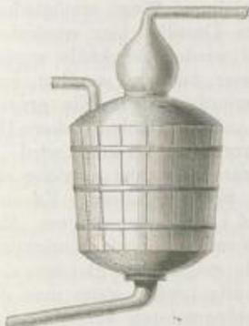
Fig. 9 zeigt eine für Dampfdestillation geeignete Form einer Blase aus Kupfer, deren dünne Seitenwände durch hölzerne Dauben verstärkt sind. Der obere und untere Boden sind gewölbt, was die Haltbarkeit erhöht, und von der tiefsten Stelle des Bodens geht das Abflussrohr für die Schlempe aus.
