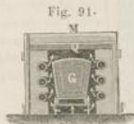
Die Leistungsfähigkeit dieses Trockenhauses ist keine bedeutende; bei einem Aufwande von 11 bis 12 Procent des zu trocknenden Torfes an Brennmaterial ist der Wasserverlust doch nur 4 bis höchstens 5 Proc. Die Ursache liegt in der
