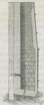
Fig. 25, 26 und 27 zeigen deren Construction. Der Wind wird durch eine oder drei Formen *e* eingeblassen, die sich auf dem nach der Vorderwand geneigten Bodenstein *b* ansammelnden Schmelzproducte fließen abwechselnd in den einen oder anderen der im Vorherde stehenden
