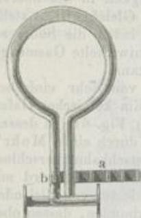
quemes Offenhalten bei verschiedener Weite der Oeffnung ist und die Stelle des von Mohr empfohlenen kleinen Keils vertritt. Das Stäbchen *a*, welches sich um ein Charnier drehen lässt, ist mit einigen Zähnen versehen, welche gegen das Stäbchen *b* drücken.
