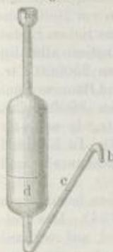
es nöthig, mindestens zweimal etwas reines Wasser durch *a* einzugiessen und durch *b* in die Abdampfschale zuzufügen und mit einzudampfen. Die ätherische Lösung giesst man in das gereinigte und tarirte kleine Becherglas zurück, spült die Pipette mit einem Gemisch von absolutem Alkohol und Aether nach und verdampft auf dem Wasserbade äusserst leicht die sehr flüchtigen Lösungsmittel der fetten Säuren und des Harzes.
