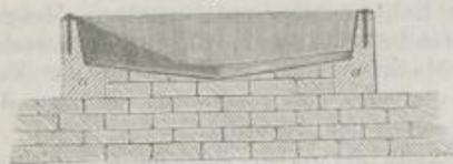
des Gefässes, sowohl seiner Länge als der Bodenfläche nach gegen die Mitte zu, lässt den tiefsten Punkt in eine der schmalen Seiten fallen.
