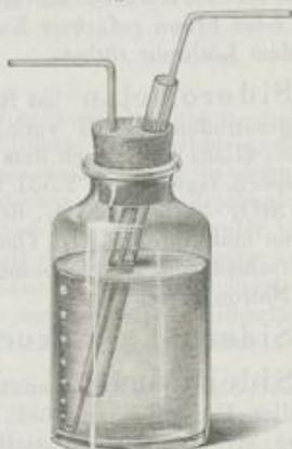
stattet, die Apparate sehr leicht zusammenzustellen und auseinander zu nehmen. Die Entwicklungsröhre ist entweder unten etwas umgebogen, wie Fig. 76 darstellt, oder man setzt die weite als Sicherheitsröhre dienende Glasröhre schief in den Kork ein (Fig. 77). V.
