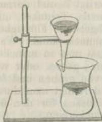
zeigt, und legt die Röhre des Trichters gegen die Wand des zum Auffangen des Filtrats bestimmten Glases, um das Umherspritzen der Flüssigkeit durch den herabfallenden Tropfen zu verhüten. Man fängt die Flüssigkeit gern in Gläsern mit nach aussen gebogenem Rande, Filtrirgläser, auf, weil sich Flüssigkeiten aus solchen leicht ausgiessen lassen. Zur Versinnlichung des Gesagten dient die nebenstehende Figur.
