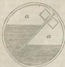
mittleren Lage der Tonne vertikal von dem Scheitel der letzteren heruntergeht, unten aber 14 Zoll von der krummen Oberfläche entfernt bleibt. In dem einen Boden jeder Tonne, nahe an der Peripherie, und auf beiden Seiten der Scheidewand sind zwei Ventile zum Einlassen und in dem entgegengesetzten Boden zwei kleinere Ventile zum Ausströmen der Luft. Die Ausströmungsöffnungen jeder Tonne sind durch eine Röhre
