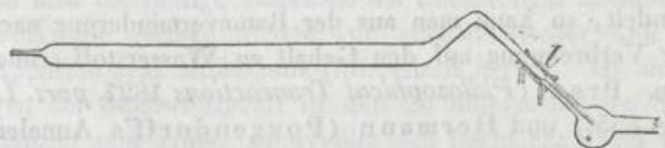
sie ist an dem Ende, welches der Chlorcalciumröhre zugekehrt ist, gekrümmt und in eine feine Spitze ausgezogen. Sie wird darauf von hinten durch die Oeffnung mit Kupferoxyd angefüllt, mit welchem man die organische Substanz gemengt hat; doch ehe man dasselbe hin-
