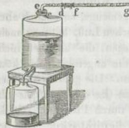
wird luftdicht eine rechtwinklicht gebogene Glasröhre *de* eingesetzt, deren horizontaler Schenkel einige Stückchen Chlorcalcium enthält, welche durch etwas lose eingesteckte Baumwolle in *d* und *e* vor
