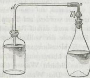
Fällen ebenfalls mit einem Korke versehen, welcher durchbohrt ist, und an welchem ein messingener Hahn *b* auf dieselbe Weise angebracht ist, wie bei der Vorrichtung, welche S. 554. abgebildet ist. Dieser Hahn *b* ist mit einer rechtwinklicht gebogenen Hülse *c* versehen, in welcher bei dem Versuche, mittelst eines durchbohrten Korkes, eine rechtwinklicht gebogene Glasröhre *d* angebracht werden kann. Man füllt die Flasche mit dem Mineralwasser an der Quelle auf die oben beschriebene Weise.
