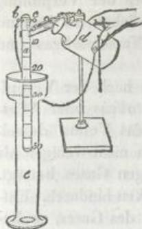
schen Funken. Dies geschieht am besten auf die Weise, daß man eine Metallkette, oder einen metallischen Draht mit einem Ende um den Draht *b* windet, und das andere Ende davon um die äußere Belegung einer geladenen Leidener Flasche *d* legt. Den Knopf der Flasche bringt man dann an den Draht *c*, wodurch ein electricischer Funken von *c* bis *b* durch das Gasgemenge springt, und dieses entzündet.
