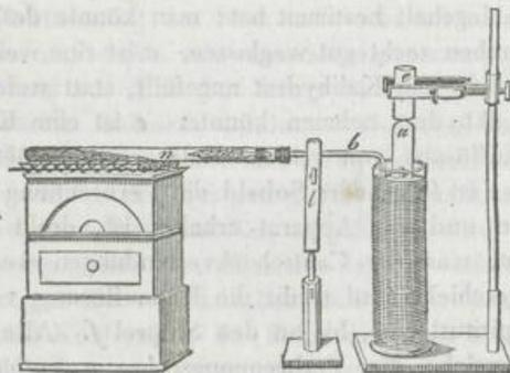
Die Leitungsröhre *b*, welche das Gas in die graduirte Glasröhre führen soll, hat zwei parallele senkrechte Arme, von denen der aufsteigende fast die Wölbung der gra-
