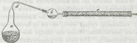
dann durch eine Cautschuckröhre mit einer kleinen Vorlage *b* in Verbindung gesetzt; die Spitze der Vorlage *b* geht in eine kleine Glasröhre *c*, welche mit Chlorcalcium gefüllt ist. Die Vorlage *b* und die Röhre *c* werden mit der Cautschuckröhre vor dem Versuche gewogen. Wenn der Apparat zusammengestellt ist, erhitzt man die Kugel *a* längere Zeit hindurch durch eine Spirituslampe. Der
