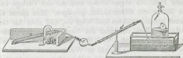
parat abgebildet. Die Vorlage mit der Röhre mit Chlorcalcium und der sie verbindenden Cautschuckröhre werden vor dem Versuche gewogen.
