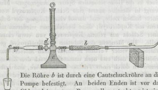
Die Röhre *b* ist durch eine Cautschuckröhre an die Pumpe befestigt. An beiden Enden ist vor das Chlorcalcium etwas Baumwolle gesteckt. *c* ist eine
