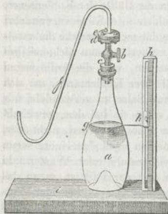
wird ein gut schließender durchbohrter Korkstöpsel eingepaßt, an welchem ein messingener Hahn *b* so angebracht wird, dafs ein mit demselben verbundenes Rohr *c* in die Durchbohrung des Korkes luftdicht zu stecken kommt. Der Hahn *b* ist oben mit einer messingenen Platte *d* versehen, auf welche eine zweite *e* sorgfältig aufgeschliffen ist.
