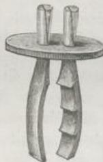
die aus Gaskohle gefeilten Polenden in der Art gehen, dass dieselben in die beiden Abtheilungen des Tiegels und das darin geschmolzene Gemisch reichen. Die Einrichtung versinnlicht Fig. 179.
