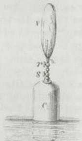
Wachskerzen angezündet in den Cylinder hinauf, so wird das Gas an der Mündung dadurch entzündet, aber die Kerze verlöscht oberhalb der brennenden Gasschicht.
