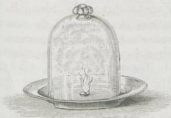
haltenen Sauerstoff und schon während der Verbrennung sieht man die Phosphorsäure: das Verbrennungsproduct, sich in Gestalt von weissen, schneeähnlichen Flokken an den Wänden der Glocke absetzen und auf den Teller herabfallen. Ist die Verbrennung beendigt und man nimmt die Glocke ab, so findet man den Teller mit einer weissen, schneeähnlichen Masse, der Phosphorsäure, bedeckt, die wegen ihrer grossen Neigung, aus der Luft Wasser anzuziehen, rasch zerfliesst. Fig. 16 zeigt die ganze Vorrichtung.
