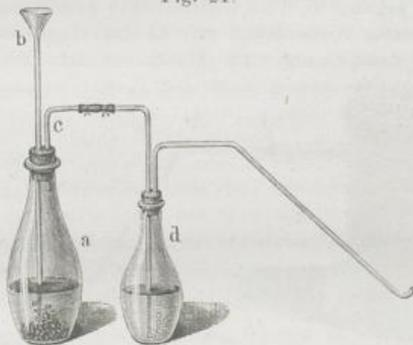
rung überflüssig. Will man das Gas reiner haben, so lässt man es, bevor man es in die pneumatische Wanne leitet, durch eine zweite Flasche, eine sogenannte Waschflasche, gehen (d. h. eine Flasche, wo das Gas gereinigt, gewaschen wird), welche zur Hälfte mit Kalilauge oder Kalkmilch gefüllt ist. Diese Flüssigkeiten halten nämlich mechanisch mit übergerissene Schwefelsäure und ausserdem Schwefelwasserstoff, eine gewöhnliche Verunreinigung des auf diesem Wege erzeugten Gases, zurück. Siehe Fig. 21.
