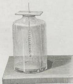
Die Verbrennung des Eisens im Sauerstoffe, eines der glänzendsten Experimente, wird in folgender Weise vorgenommen: Man windet eine ausgeglühte dünne Uhrfeder spiralförmig auf, steckt das obere Ende in einen Kork, auf das untere aber etwas Zunder. Man zündet den Zunder an und senkt die Spirale in eine mit Sauerstoff gefüllte Flasche, in der man aber zweckmässig noch so viel Wasser gelassen hat, dass es den Boden
