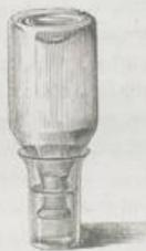
von der atmosphärischen Luft ab. Sind Flaschen mit Gas zu füllen und dasselbe aufzubewahren, so zieht man sie in dem Maasse, als sie gefüllt sind, von der Brücke der pneumatischen Wanne, ohne ihre Stellung zu ändern, verkorkt sie mit der Mündung nach unten, unter Wasser, hebt sie hierauf heraus und stellt sie in Gefässe, welche so weit mit Wasser gefüllt und tief genug sind, um die Mündung von der Luft abzusperren. Fig. 7 macht die Art der Aufbewahrung von Gasen in Flaschen deutlich.
