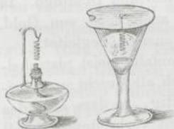
Man kann diesen Versuch auch in der Fig. 162 versinnlichten Weise modificiren. Am Boden des Kelchglases befindet sich etwas Aether. Die an einer Pappscheibe befestigte Platinspirale wird zum Rothglühen erhitzt, und dann mittelst der Pappscheibe, die nicht luftdicht schliessen darf, auf das Glas aufgesetzt. Die Spirale fährt fort zu glühen.
