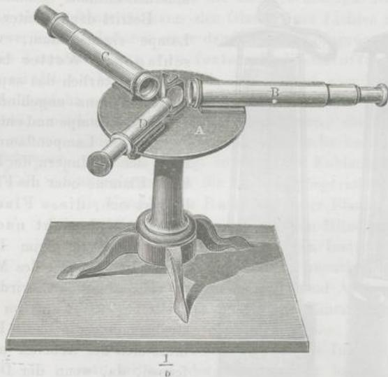
Mittelst dieses Apparates lässt man die Strahlen der gefärbten Flammen zunächst durch einen engen Spalt, sodann durch ein Prisma fallen, und beobachtet dann das so erzeugte Spectrum mittelst eines Fernrohrs.
