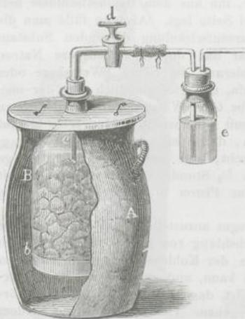
Der ganze Apparat besteht aus drei Theilen, dem Apparat zur Erzeugung der Kohlensäure, einer Druckpumpe, und dem Verdichtungsgefässe.
