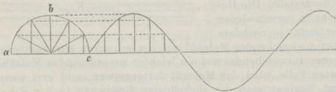
Hälfte des abzurollenden Kreises. Die Peripherie ist in gleiche Stücke getheilt und auf der Abscissenaxe abgetragen. Die Ordinaten sind dem Sinus der zugehörigen Bogen, multiplicirt mit dem Halbmesser, gleich gemacht. Würde ich die Zahlen für die Sinus nicht mit dem Halbmesser des abgerollten Kreises, sondern mit irgend einer kleineren Grösse multiplicirt haben, so würde ich ein Wellensystem von kleinerer Amplitude, aber immer noch das Bild von pendelartigen Schwingungen erhalten haben.
