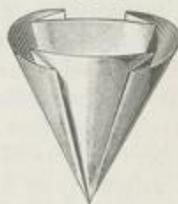
werden die Flächen 2 und 8 je zur Hälfte hinter 1, sowie 4 und 6 je zur Hälfte hinter 5 gebogen und das Filter ist fertig (Fig. 77).
