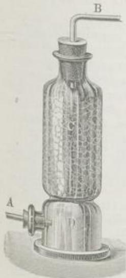
Zum Trocknen von Gasen finden die Bd. IV, pag. 528, beschriebenen und abgebildeten Gaswaschapparate Anwendung, indem man sie mit concentrirter Schwefelsäure statt mit Wasser beschickt. Ferner verwendet man U-förmig gebogene Glasröhren, gefüllt mit Chlorcalcium oder mit Bimsteinstücken, Glassecherben, Glasperlen, die mit concentrirter Schwefelsäure befeuchtet sind (s. unter Elementaranalyse, Bd. III, pag. 687).
