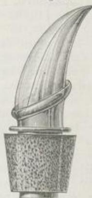
**Tropfglas, Tropfenzähler**, eine kleine Vorrichtung, mit deren Hilfe Flüssigkeiten tropfenweise abgemessen oder abgezählt werden können.
