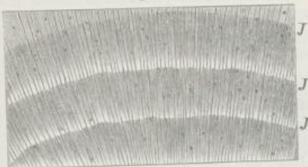
Querschnitt durch Föhrenholz unter der Loupe.
