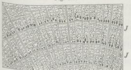
Querschnitt durch Eichenholz unter der Loupe. J Grenze der Jahresringe.
