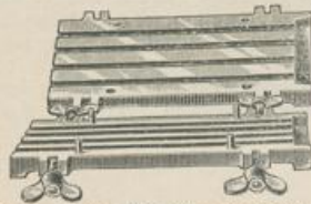
Gussform für Stangencerate von Rob. Liebau in Chemnitz.
