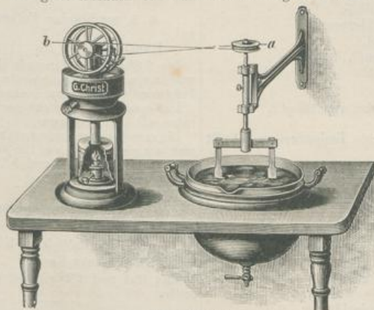
Extraktrührer, betrieben durch den Christ'schen Heissluftmotor.
