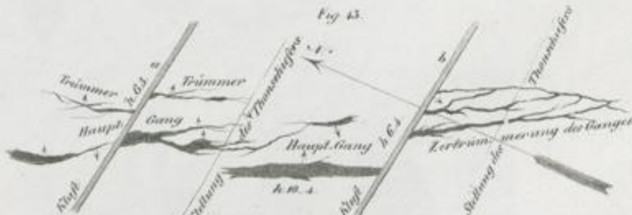
Verwerfung des S. Andreas-Kreuzer Haupt-Ganges a in N. d. Lachter-Tiefe b in W. d. Lachter-Tiefe.
