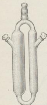
Abb. 2. Zersetzungsgefäß nach Soxhlet.
