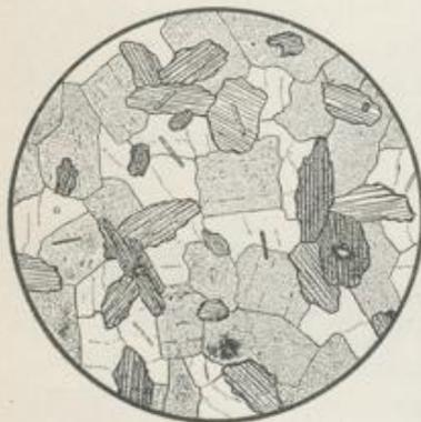
Fig. 23. Körniges Gefüge von Granit.
