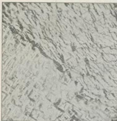
Thomasflusseisen. C = 0,25 Proc. Querschliff durch gegossenen Block.
