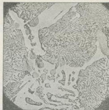
Thomasroheisen. 108 Stunden in Holzkohle gegläht. Reliefpolirt. Cementit in Relief gegen Perlit. Durch das Glühen ist der ursprünglich weniger deutlich ausgeprägte Perlit in die typische Form von Figur 191 gebracht worden.
