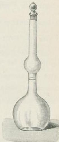
Abb. 25. Maßkolben mit kugelförmiger Ausbauchung über der Marke.
