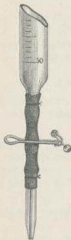
Abb. 9. Verschluss einer Bürette mittels eines Quetschhahnes.
