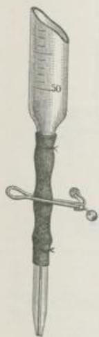
Abb. 9. Verschuß einer Bürette mittels eines Quetschhahnes.
