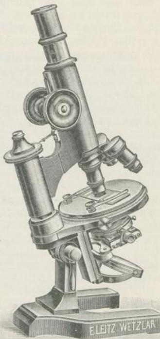
Abb. 10. Mikroskop von E. Leitz-Wetzlar. Stativ Ia mit Abbeschem Beleuchtungsapparat und Irisblende, 3 fachem Revolver, Objekt 3, 6, 8, Okul. 1, 3; Vergröß. 60–550. — Preis 305 Mk. Bei derselben Firma sind auch für einfachere Untersuchungen völlig geeignete Mikroskope schon zum Preise von 80 Mk. erhältlich.
