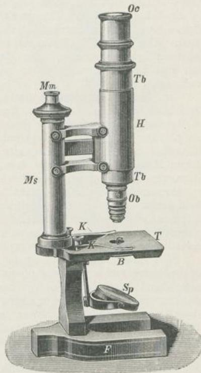
Abb. 9. Mikroskop. *F* Fuß, *T* Objektisch, *O* Objektischöffnung, *B* Blende, *Sp* Spiegel, *K* Klemmen, *M* Mikroskopssäule, *Mm* Mikrometerschraube, *H* Hülse, *Tb* Tubus, *Ob* Objektiv, *Oc* Okular.
