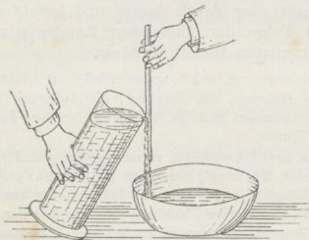
Fig. 2. Adhäsion beim Ausgiessen von Flüssigkeiten.
