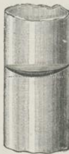
Abb. 83. Flüssigkeitsoberfläche in der Bürette.
