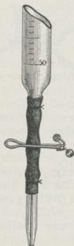
Abb. 74. Verschluß einer Bürette mittelst eines Quetschhahnes.
