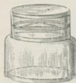
Abb. 62. Exsikkator mit aufgeschliffenem Deckel und eingelegtem Glasabdreieck als Träger.
