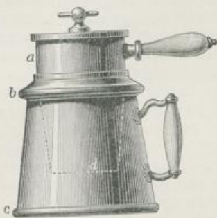
Abb. 5. Einfaches Handdekoktorium. a b Aufgüßbüchse. b c Wasserbad.
