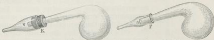
Abb. 99. Retorten mit Vorstoß. In Abb. 99 ist der Hals v durch den Kork K flüssigkeitsdicht eingepaßt, in Abb. 100 der Hals a bei P nur in das Glas eingesteckt, weil hier organische Masse vermieden werden soll.
