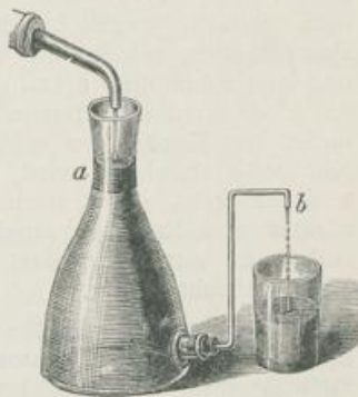
Abb. 95. Florentiner Flasche. Bei a sammelt sich das ätherische Öl, bei b fließt das Wasser ab.
