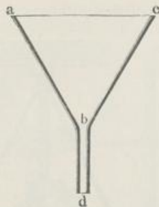
Abb. 71. Trichter von 60° Spannung mit richtig gebantem Ablauf b d .
