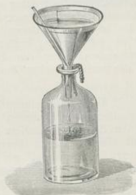
Abb. 84. Filtration mit eingehängtem Bindfaden und unter das Filter geschobenem Glasstab, um die Luft aus der Flasche zu lassen.
