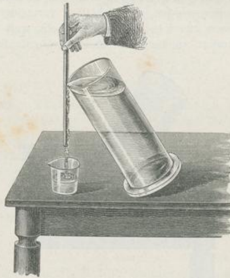
Fig. 43. Giessen mit angelegtem Glasstab.
