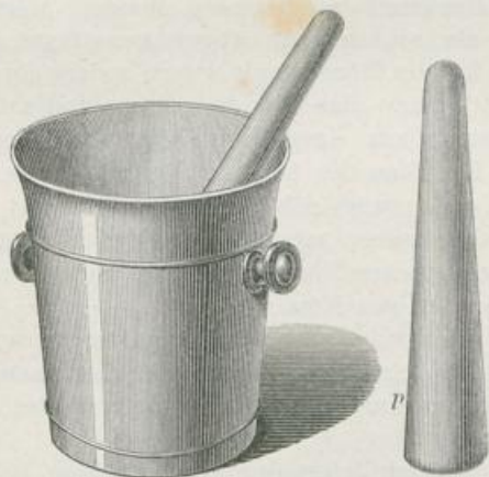
Fig. 8. Emulsionsmörser aus Porzellan; p Mörserkeule von Buchsbaumholz.
