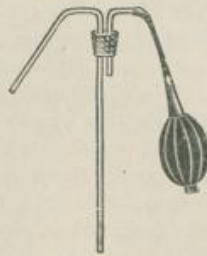
Fig. 4. Druckheber zur Entnahme flüssiger Luft aus der Kanne.
