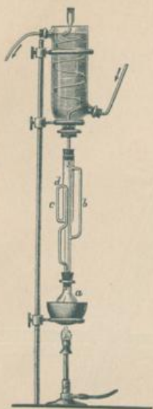
Soxhlet'scher Extractionsapparat nach Szombathi.
