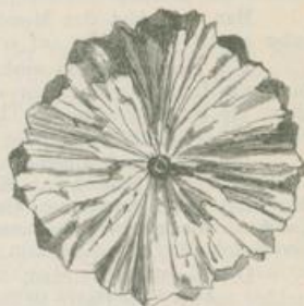
Fig. 122. Querbruchfläche einer Milchzuckerstange. Die Krystalle strahlig um ein Stäbchen aggregirt. Natürl. Grösse.
