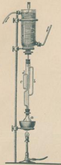
Soxhlet'scher Extractionsapparat nach Szombathi.
