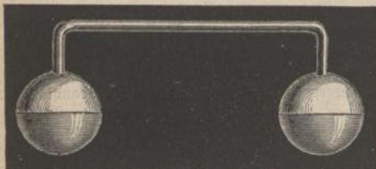
Kugeln endet, die etwas Wasser enthalten, aber luftleer sind (Fig. 319). Bringt man die eine dieser Kugeln in eine Kälte erregende Mischung (vergleiche oben S. 236), z. B. in eine Mischung von Kochsalz und Schnee, so werden die in derselben enthaltenen Wasserdämpfe condensirt; in Folge hiervon tritt in der anderen, außerhalb der Mischung befindlichen
