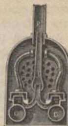
findet sich ein bewegliches Schieberventil, welches bei der in der Fig. 323 abgebildeten Stellung die Dämpfe an die rechte Seite des Kolbens treten läßt, während die an der linken Seite befindlichen Dämpfe in den Raum n entweichen und aus diesem durch die Röhren o und p in den Schornstein E fortgeführt werden.
