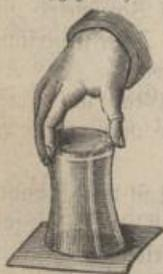
Wenn man ein Glas mit Wasser füllt, dann mit einem Stücke Papier bedeckt und dieses mit der flachen Hand fest an den Rand des Glases andrückt, so kann man das Glas umkehren und die Hand wegziehen, ohne daß das Wasser ausläuft. — Dieser einfache Versuch zeigt eben so, wie der Torricellische, das Vorhandensein des Luftdruckes, gibt aber über die Größe desselben keinen Aufschluß.
