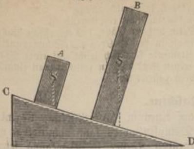
Der Körper A (Fig. 36), welcher von der schiefen Unterlage CD getragen wird, ruht auf derselben mit Stabilität, weil das durch den Schwerpunkt S gezogene Lot die unterstützte Fläche durchschneidet; der Körper B muß dagegen umfallen, weil für denselben diese Bedingung nicht erfüllt ist. — Ein hoch beladener Wagen, überhaupt Körper, deren Schwerpunkt hoch liegt, fallen unter übrigens gleichen Umständen leichter um, als solche, deren Schwerpunkt niedrig liegt.
