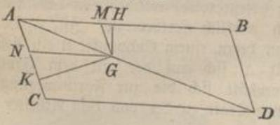
Wenn man aus irgend einem Punkte G der Resultirenden AD zweier Kräfte  $AB = P$  und  $AC = Q$  (Fig. 23) Lote auf die Richtungen derselben fällt, so verhalten sich diese Lote GH und GK umgekehrt wie die gegebenen Kräfte. Denn wenn man noch  $GM \parallel AC$  und  $GN \parallel AB$ , zieht, so ist  $\triangle GHM \sim \triangle GKN$ , folglich verhält sich  $GH : GK = GM : GN = AC : AB = Q : P$ .
