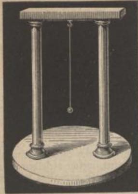
erfolgten die Schwingungen des Pendels in der Richtung von Norden nach Süden, so daß sie also die Ebene des Gestelles senkrecht durchschnitten, so wird nach einer Umdrehung des Gestelles um  $90^\circ$  die Ebene desselben mit der Schwingungsebene des Pendels, welche unverändert die Lage von Norden nach Süden beibehält, zusammenfallen; bei weiterer Drehung um  $90^\circ$  dieselbe wieder senkrecht durchschneiden u. s. f.
