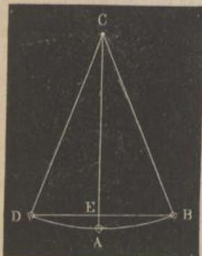
Diese Voraussetzungen treffen jedoch beim Pendel nicht mit voller Genauigkeit, sondern nur annähernd zu. Ist nämlich B (Fig. 65) der schwere Punkt eines mathematischen Pendels, welches mit der lotrechten Linie AC einen Winkel  $ACB = \alpha$  bildet, und denken wir uns durch B eine Tangente an den Bogen AB gezogen, so ist der Neigungswinkel derselben gegen den Horizont, wie leicht zu sehen, gleich  $ACB = \alpha$ , folglich die beschleunigende Kraft der Schwere (nach §. 32 und 38, a) gleich
