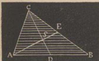
ABC (Fig. 28) wird gefunden, wenn man die Mitten zweier Seiten D und E mit den gegenüberliegenden Ecken C und A verbindet. Der Durchschnittspunkt S dieser Verbindungslinien ist der gesuchte Schwerpunkt. Denn wenn man sich das Dreieck ABC durch Linien parallel zu AB gezogen in sehr schmale Streifen getheilt denkt, so werden diese Streifen sämtlich durch CD halbiert. In der Linie CD müssen
