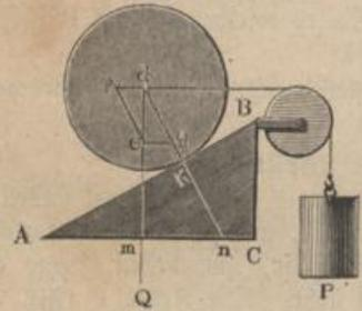
Soll die Last Q durch eine wagerecht wirkende Kraft P (Fig. 51) im Gleichgewichte erhalten werden, so muß sich die Kraft zur Last verhalten, wie die Höhe BC zur Basis AC. — Da die Basis allemal kleiner, als die Länge ist, so sieht man leicht, daß in diesem Falle eine
