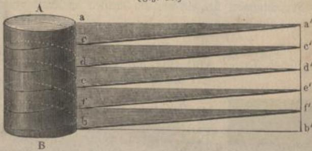
aufgerollt, dasselbe durch Parallelen mit der Grundlinie in kleinere Rechtecke zer schnitten, welche alle eine gleiche Höhe haben, und in diesen Rechtecken parallele Diagonalen gezogen. Wird nun das Rechteck aa'bb' wieder um den Cylinder gerollt, so bilden diese Diagonalen eine zusammenhängende krumme Linie, welche überall unter demselben Winkel  $a'ce' = c'dd' = d'ee'$  u. s. w. gegen die Grundfläche des Cylinders geneigt ist und Schraubenlinie genannt wird.
