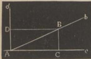
Größen der Seitenkräfte, wenn man durch B mit Ac die Parallele BD und mit Ad die Parallele BC zieht. AC und AD sind die gesuchten Seitenkräfte, welche zusammen eben dasselbe leisten, als die eine Mittelkraft AB.
