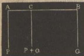
Wenn ferner auf verschiedene Punkte eines festen Körpers zwei parallele Kräfte P und Q (Fig. 14) nach derselben Seite wirken, so ist die Resultirende gleich der Summe der beiden gegebenen Kräfte  $P + Q$ . Sind diese einander gleich, so liegt der Angriffspunkt C der Resultirenden in der Mitte zwischen A und B. Sind die gegebenen Kräfte ungleich, so theilt der Angriffspunkt C der Resultirenden die Entfernung AB der
