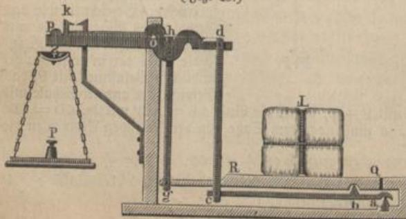
der Stange hg getragen, welche an dem um o beweglichen Hebelarm dp befestigt ist, andererseits ruht dieselbe auf der Schneide b, welche an dem um a drehbaren Hebelarme ac angebracht ist, dessen anderes Ende c durch die Stange od ebenfalls mit dem Hebelarme dp verbunden ist, welcher an dem entgegengesetzten Ende p die zur Aufnahme der Gewichte bestimmte
