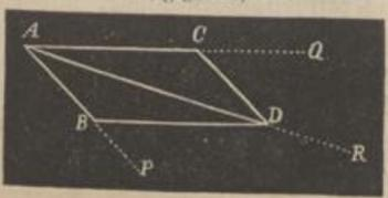
Für die mit der Trigonometrie vertrauten Leser fügen wir noch Folgendes hinzu: Ist  $\alpha$  der von den Seitenkräften P und Q eingeschlossene Winkel BAC (Fig. 24) und R die Resultirende
