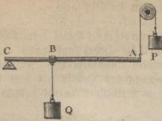
Seiten vom Unterstützungspunkte angebracht sind, so heißt der Hebel zweiarmig (Fig. 38); liegen aber beide an derselben Seite vom Unterstützungspunkte (Fig. 39), so wird der Hebel einarmig genannt. Man unterscheidet ferner gradlinig, Winkel- und krummlinige Hebel, je nachdem die Hebelarme eine gerade Linie oder einen Winkel bilden oder aus krummen Linien bestehen. — Von allen Arten von Hebeln aber gilt das Gesetz: Am
