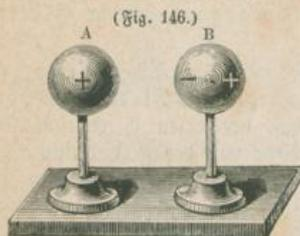
z. B. der gehörig isolirten Kugel A (Fig. 146) auf irgend eine Art positive Electricität mit und nähern dann derselben die ebenfalls isolirte Kugel B, so wird auch in dieser das electricische Gleichgewicht aufgehoben, die positive Electricität abgestoßen, die negative aber angezogen. Werden beide Kugeln A und B einander so weit genähert, daß die Anziehung der entgegengesetzten Electricitäten in A und B den Leitungswiderstand
