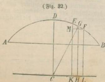
werden wir diesen unendlich kleinen Bogen EF ohne erheblichen Fehler mit seiner Sehne verwechseln und annehmen können, daß sein Schwerpunkt in den Halbierungspunkt  $G$  fällt. Ziehen wir nun durch den Mittelpunkt  $C$  eine zum Radius  $CD$  senkrechte Linie und fällen auf dieselbe das Lot  $GH$ , so ist das statische Moment des Bogens  $EF$  für die Linie  $CH$  als Axe gleich  $EF \cdot GH$ .
