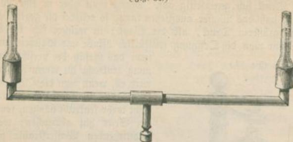
besteht, die an ihren Enden zwei senkrecht in die Höhe gehende gläserne Cylinder trägt. Die Oberflächen des Wassers in den beiden Glascyllindern liegen allemal in einer wagerechten Linie.
