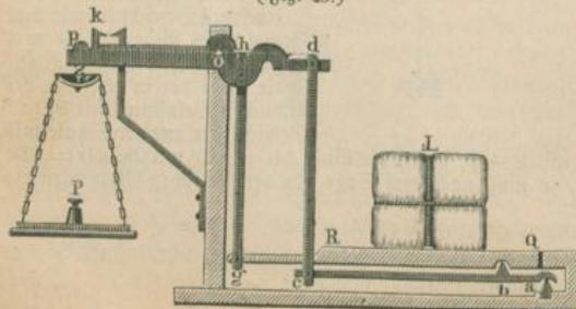
der Stange  $hg$  getragen, welche an dem um  $o$  beweglichen Hebelarm  $dp$  befestigt ist, andererseits ruht dieselbe auf der Schneide  $b$ , welche an dem um  $a$  drehbaren Hebelarme  $ac$  angebracht ist, dessen anderes Ende  $c$  durch die Stange  $cd$  ebenfalls mit dem Hebelarme  $dp$  verbunden ist, welcher an dem entgegengesetzten Ende  $p$  die zur Aufnahme der Gewichte bestimmte
