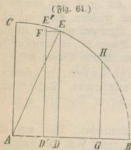
diese Voraussetzungen offenbar von der Gestalt der Bahn ganz unabhängig sind, so werden wir dieselbe am einfachsten als eine gerade Linie AB zeichnen. Nach unserer Annahme ist die beschleunigende Kraft im Punkte B, also auch die Geschwindigkeit, welche dieselbe, wenn sie mit unveränderlicher Stärke wirkte, dem bewegten Körper in der Zeiteinheit erteilen würde, der Größe des Weges AB proportional. Bezeichnen wir das Verhältniß dieser Geschwindigkeit zu dem Wege AB mit  $k$ , so gibt das Product
