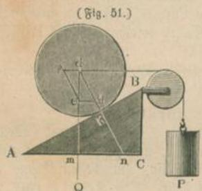
Soll die Last Q durch eine wagerecht wirkende Kraft P (Fig. 51) im Gleichgewichte erhalten werden, so muß sich die Kraft zur Last verhalten, wie die Höhe BC zur Basis AC. — Da die Basis allemal kleiner, als die Länge ist, so sieht man leicht, daß in diesem Falle eine größere Kraft erforderlich ist, um das Gleichgewicht herzustellen, als im vorhergehenden.
