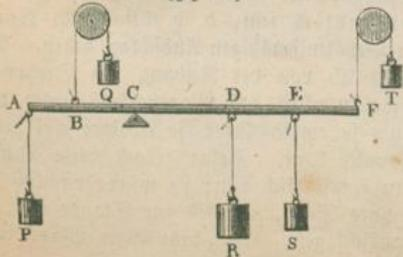
Wirken auf einen Hebel mehr als zwei Kräfte, z. B. auf den Hebel AF (Fig. 41) die Kräfte P, Q, R, S und T, von denen P und T den Hebel nach der einen Seite, Q, R und S aber nach der entgegengesetzten Seite zu drehen streben, so findet das Gleichgewicht statt, wenn die Summe der statischen Momente der Kräfte, welche den Hebel nach der einen Seite
