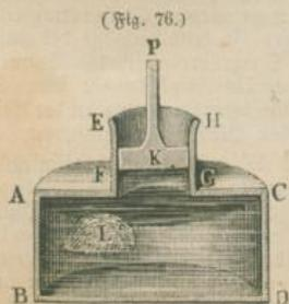
uns den Sinn dieses Satzes zu verdeutlichen, denken wir uns ein cylinderförmiges Gefäß ABCD (Fig. 76), welches mit Wasser angefüllt ist und in einen cylinderförmigen Hals EFGH ausläuft. Wird mittelst eines beweglichen, aber dicht anschließenden Kolbens K auf das Wasser ein Druck P ausgeübt, welchen wir als groß genug annehmen wollen, daß wir gegen denselben das eigene Gewicht des Flüssigen als unbedeutend außer Acht lassen können, so erleidet auch jede mit der Grund-
