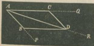
Für die mit der Trigonometrie vertrauten Leser fügen wir noch Folgendes hinzu: Ist  $\alpha$  der von den Seitenkräften P und Q eingeschlossene Winkel BAC (Fig. 24) und R die Resultirende
