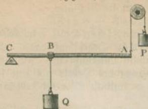
Seiten vom Unterstützungspunkte angebracht sind, so heißt der Hebel zweiarmig (Fig. 38); liegen aber beide an derselben Seite vom Unterstützungspunkte (Fig. 39), so wird der Hebel einarmig genannt. Man unterscheidet ferner gradlinige, Winkel- und krummlinige Hebel, je nachdem die Hebelarme eine gerade Linie oder einen Winkel bilden oder aus krummen Linien bestehen. — Von allen
