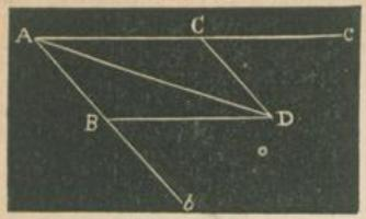
darstellen, einen Winkel BAC einschließen, so wird die Resultirende gefunden, wenn man aus den Seitenkräften AB und AC das Parallelogramm ABDC vollendet und die Diagonale AD zieht. Diese zeigt sowohl die Richtung als auch die Größe der resultirenden Kraft an.
