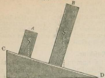
Der Körper A (Fig. 36), welcher von der schiefen Unterlage CD getragen wird, ruht auf derselben mit Stabilität, weil das durch den Schwerpunkt S gezogene Lot die unterstützte Fläche durchschneidet; der Körper B muß dagegen umfallen, weil für denselben diese Bedingung nicht erfüllt ist. — Ein hoch beladener Wagen, überhaupt Körper, deren Schwerpunkt hoch liegt, fallen unter übrigens gleichen Umständen leichter um, als solche, deren Schwerpunkt niedrig liegt.
