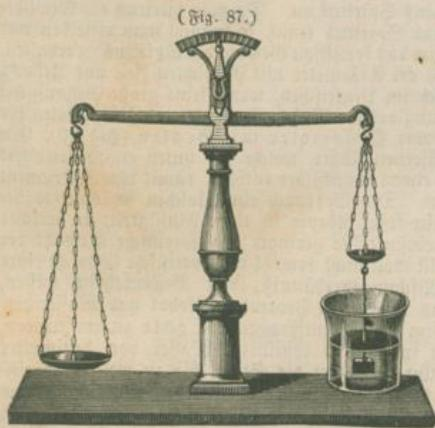
Bei der Bestimmung des specifischen Gewichtes fester Körper wendet man gewöhnlich eine Wage (Fig. 87) an, deren eine Wagschale höher aufgehängt ist, als die andere und unten einen Haken hat, an welchem der zu untersuchende Körper aufgehängt wird. Man nennt eine solche Wage eine hydrostatische.
