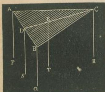
Wirken auf einen festen Körper drei parallele Kräfte, z. B. in den Punkten A, B und C (Fig. 15) die Kräfte  $P = 3$ ,  $Q = 4$  und  $R = 5$ , so lassen sich zunächst zwei derselben, P und Q in eine Resultirende  $S = P + Q = 7$  vereinigen; und man findet den Mittelpunkt D dieser Kraft, wenn man die Linie AB in D so theilt, daß sich  $AD : BD = Q : P = 4 : 3$  verhält. — Wenn man nun die Kraft S mit der Kraft R zu einer Resultirenden  $T = S + R = 12$  verbindet und,
