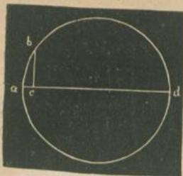
Körper in der Zeiteinheit von der durch  $a$  gehenden Tangente, welche er vermöge des Trägheitsgesetzes zu durchlaufen strebt, entfernt hat und kann daher als Maß der Schwungkraft dienen. Da wir den Bogen  $ab$  sehr klein angenommen haben, so werden wir denselben süglich mit der Sehne  $ab$  verwechseln dürfen. Denken wir uns noch  $bd$  gezogen, so ist in dem rechtwinkligen Dreiecke  $abd$
