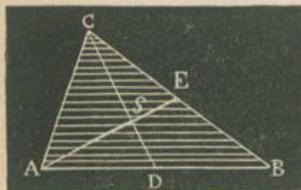
ABC (Fig. 28) wird gefunden, wenn man die Mitten zweier Seiten D und E mit den gegenüberliegenden Ecken C und A verbindet. Der Durchschnittspunkt S dieser Verbindungslinien ist der gesuchte Schwerpunkt. Denn wenn man sich das Dreieck ABC durch Linien parallel zu AB gezogen in sehr schmale Streifen getheilt denkt, so werden diese Streifen sämmtlich durch CD halbirte. In der Linie CD müssen
