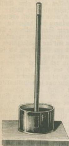
wie dies nach dem Gesetze der communicirenden Röhren geschehen sollte, in gleiche Höhe mit dem Quecksilber im Gefäße, sondern bleibt nach einigen Schwankungen in der Röhre in einer Höhe von ohngefähr 28 (Pariser) Zoll\*) über dem Quecksilber im Gefäße stehen.
