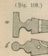
Wird der Kolben in die Höhe gezogen, hat der Hahn die in Fig. 109, a abgebildete Stellung; die in dem Recipienten E und der Röhre C enthaltene Luft dehnt sich in den Stiefel A aus und wird folglich verdünnt. Damit sie aber beim Niedergange des Kolbens sich nicht wieder verdichte, wird vorher der Hahn D um 90° in die Fig. 109, b abgebildete Stellung gedreht, hierdurch die Röhre C und der Recipient E ab-
