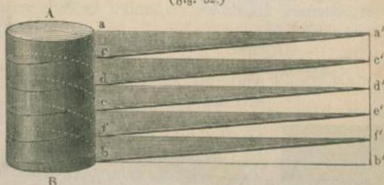
aufgerollt, dasselbe durch Parallelen mit der Grundlinie in kleinere Rechtecke zerschnitten, welche alle eine gleiche Höhe haben, und in diesen Rechtecken parallele Diagonalen gezogen. Wird nun das Rechteck  $aa'bb'$  wieder um den Cylinder gerollt, so bilden diese Diagonalen eine zusammenhängende krumme Linie, welche überall unter demselben Winkel  $a'co' = c'dd' = d'ee'$  u. s. w. gegen die Grundfläche des Cylinders geneigt ist und Schraubenlinie genannt wird.
