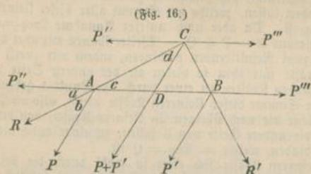
Dennoch wenn wir zu den beiden gleichen und parallelen Kräften  $P$  und  $P'$  (Fig. 16), deren Angriffspunkte  $A$  und  $B$  sind, zwei ihnen gleichgroße Kräfte  $P''$  und  $P'''$  in den Punkten  $A$  und  $B$  so hinzufügen, daß die Richtungen derselben in die Verlängerungen der Linie  $AB$  fallen, so wird hierdurch nichts geändert, da sich die beiden gleichen und entgegengesetzten Kräfte  $P''$  und  $P'''$  gegen-
