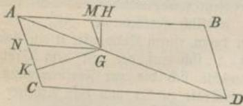
Wenn man aus irgend einem Punkte G der Resultirenden AD zweier Kräfte  $AB = P$  und  $AC = Q$  (Fig. 23) Lote auf die Richtungen derselben fällt, so verhalten sich diese Lote GH und GK umgekehrt wie die gegebenen Kräfte. Denn wenn man noch  $GM \parallel AC$  und  $GN \parallel AB$ , zieht, so ist  $\triangle GHM \sim \triangle GKN$ , folglich verhält sich  $GH : GK = GM : GN = AC : AB = Q : P$ .
