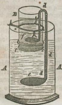
In ein gläsernes oder feineres Gefäß A wird ein zweites etwa nur halb so hohes Gefäß B entweder vermittelst eines ungebogenen Randes oder eines um dasselbe herumgelegten mit Haken versehenen Drahtringes o hineingehängt. Der Boden des kleineren Gefäßes ist abgeschnitten und durch eine ungebundene Thierblase c ersetzt. Ein vielleicht ¼ Zoll breiter Streifen von Kupferblech ddd,
